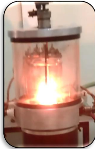
Figure II.19 : Evaporation de la poudre d'Aluminium.
