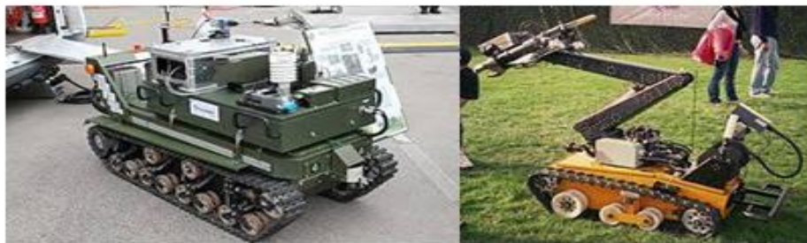
Figure 1-3: Les robots mobiles à chenilles
