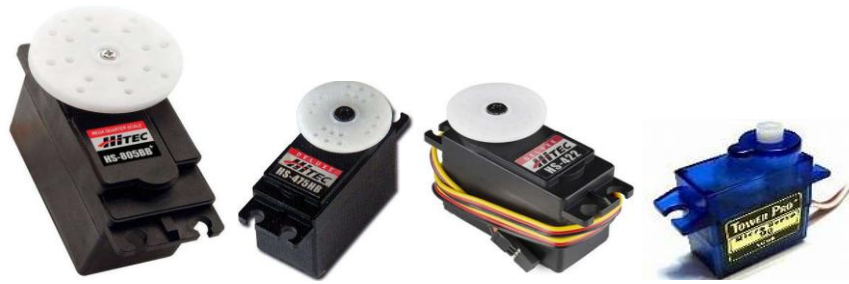
Figure 4-4: Servomoteurs utilisés dans le bras manipulateur
