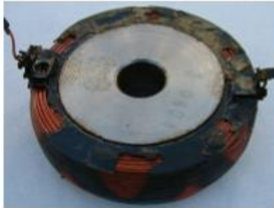
Figure 1.12. Vue de la bobine d'excitation Et du noyau de l'alternateur
