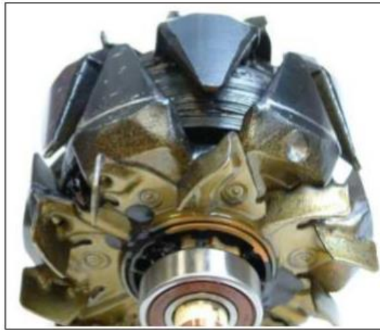
Figure 1.19. Le refroidissement par ventilateur
