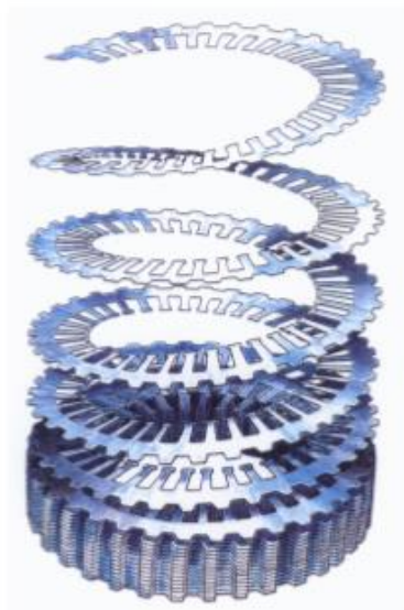
Figure 1.5. Process slinky, construction du stator en hélice
