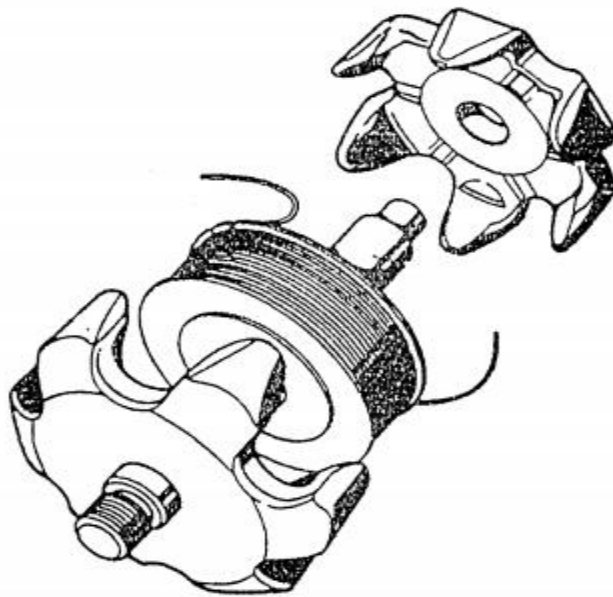
Figure 1.11. Schéma éclaté d'un rotor à griffes
