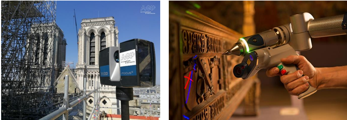
Figure 3: Balayage 3D. A droite: laser à longue portée, A gauche: Scanner par triangulation. Source: www.artgp.fr/
