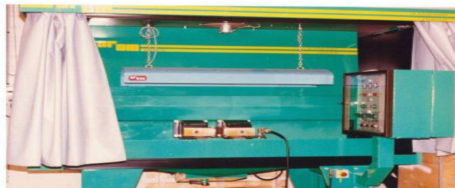
Fig.III.35.contrôle par magnétoscopie
