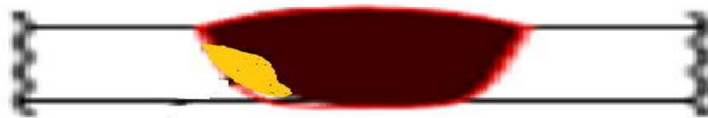
Fig.III.21. Manque de fusion à la racine.
