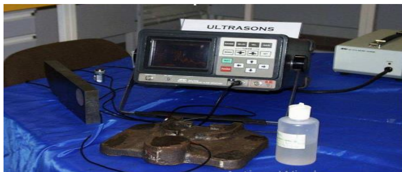
Fig.III.34. Contrôle de pièce fonderie.
