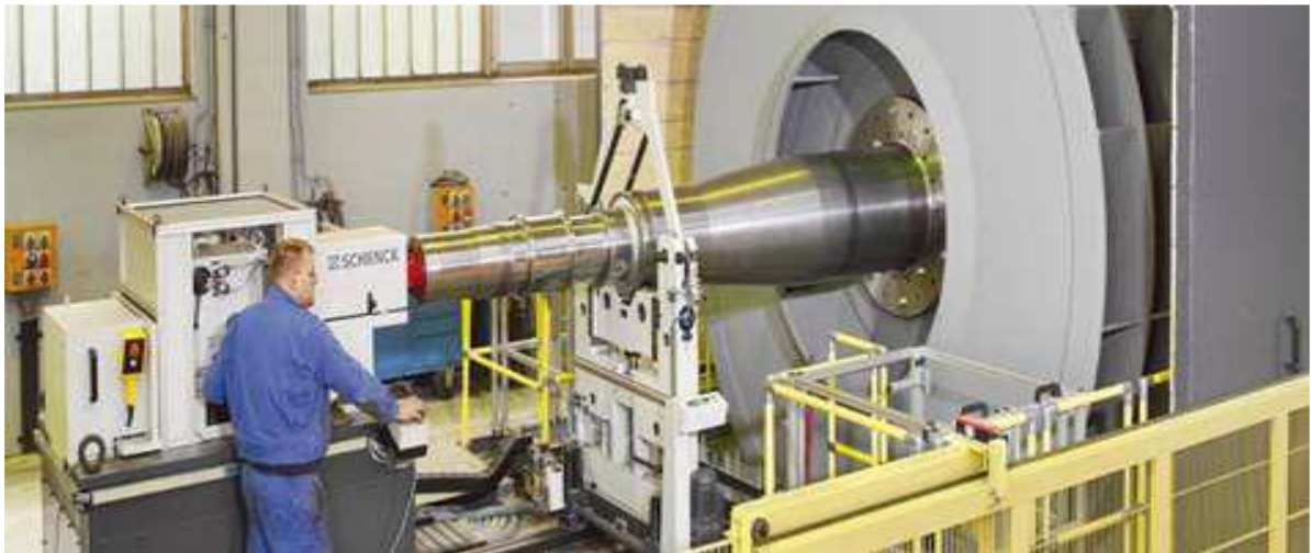
Figure II. 17 : Balance d'équilibrage statique utilisée pour des Rotors Turbomachine.
