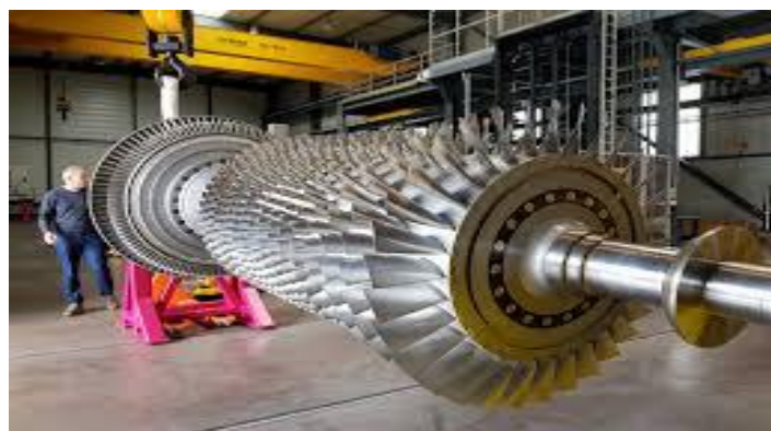
Figure II. 11 : Image illustrant un Rotor d'une turbine à gaz
