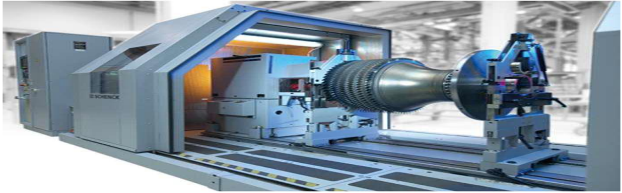
Figure II. 21 : Machine à équilibrer moderne pour une utilisation universelle
