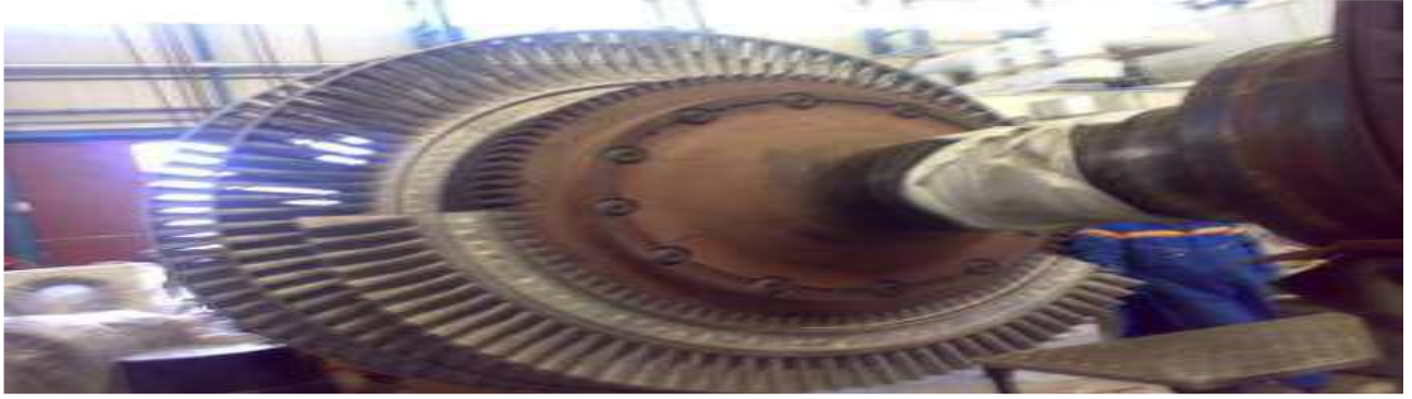
Figure II. 20 : Procédure de répartition des aubes d'un rotor d'une turbine à gaz 9FB
