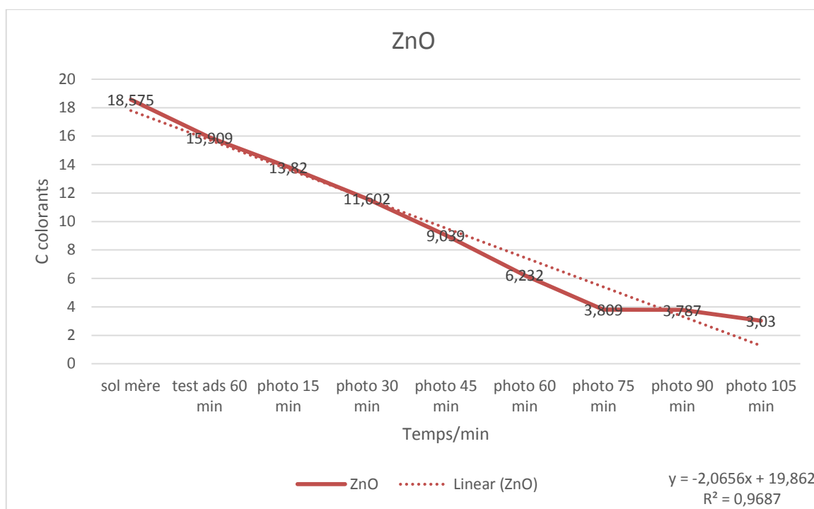
Figure 4.3 : Cinétique de dégradation R6G sous irradiation en présence de ZnO.
