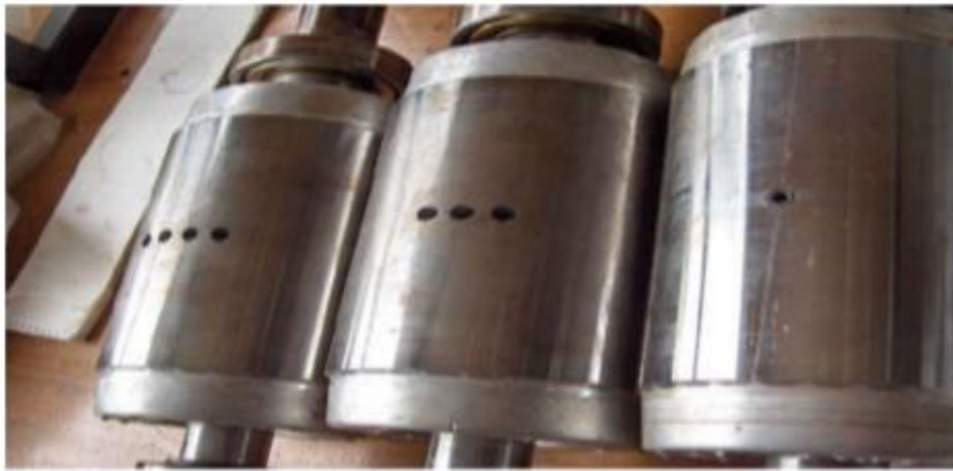
Figure 1.18 : Ruptures de barres.
