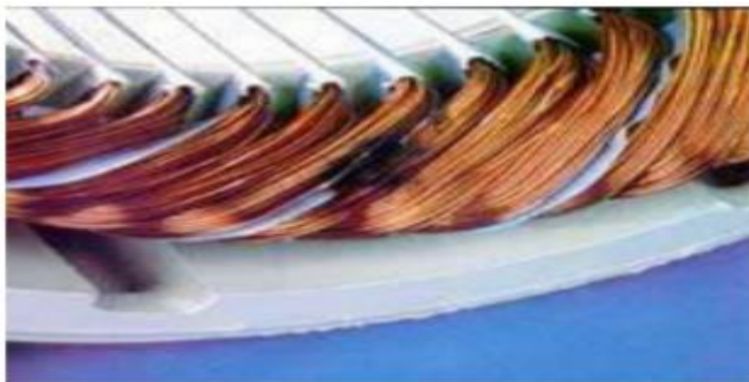
Figure 1.17 : Court-circuit entre spire [29].
