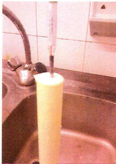
**Figure 1** : Mesure de la densité par lactodensimètre
