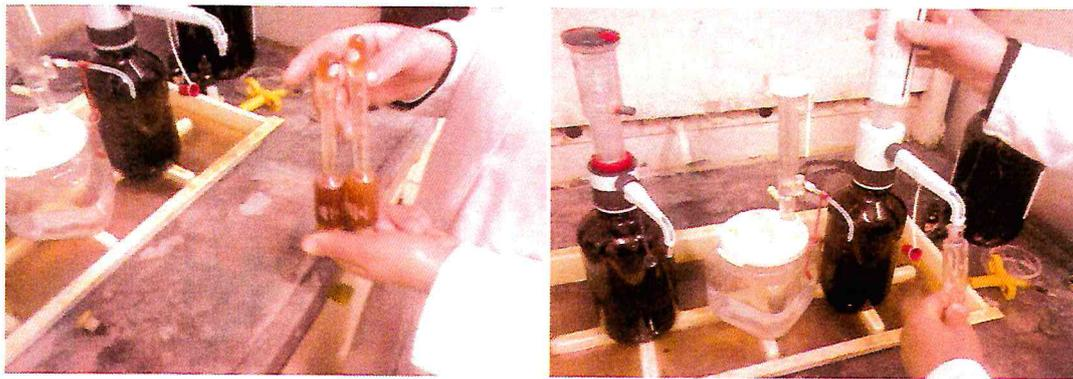
**Figure 5** : Dissolution des protéines    **Figure 4** : Préparation du butyromètre
