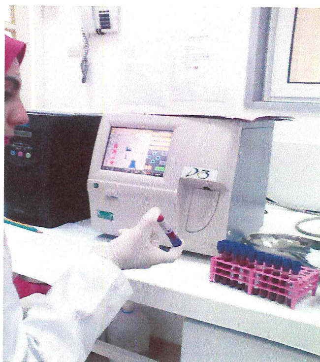
Une fois l'automate réglé, les tubes de prélèvements sont retournés pour homogénéisation. (Figure 18) puis une fois ouverts ils sont passés sous l'aiguille du Coulter qui aspire une petite quantité de sang (Figure 19), l'analyse se fait automatiquement et les résultats s'affichent sur l'écran. (Figure 20).
