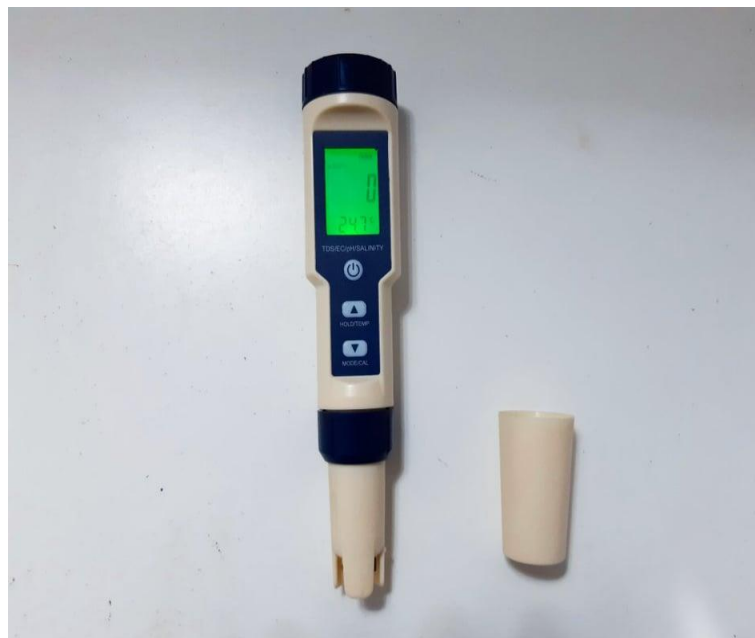
Fig.20 : Sonde utilisée pour les mesures sur terrain.(16/08/2020)
