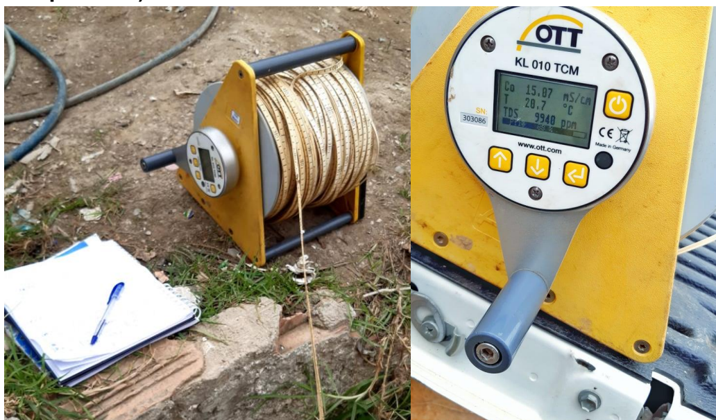
Fig.18: Sonde multi paramètres utilisée pour la mesure de différents paramètres
