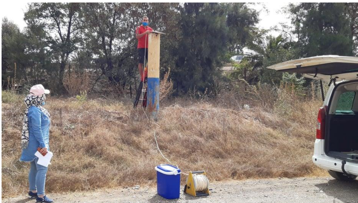
Fig.22 : Mesures du niveau statique sur les piézomètres au niveau de la Baie d'Alger. (16/08/2020)
