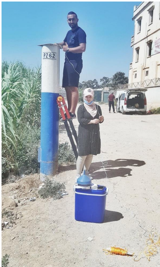
Fig.28 : Prélèvement d'échantillon PZ 62
