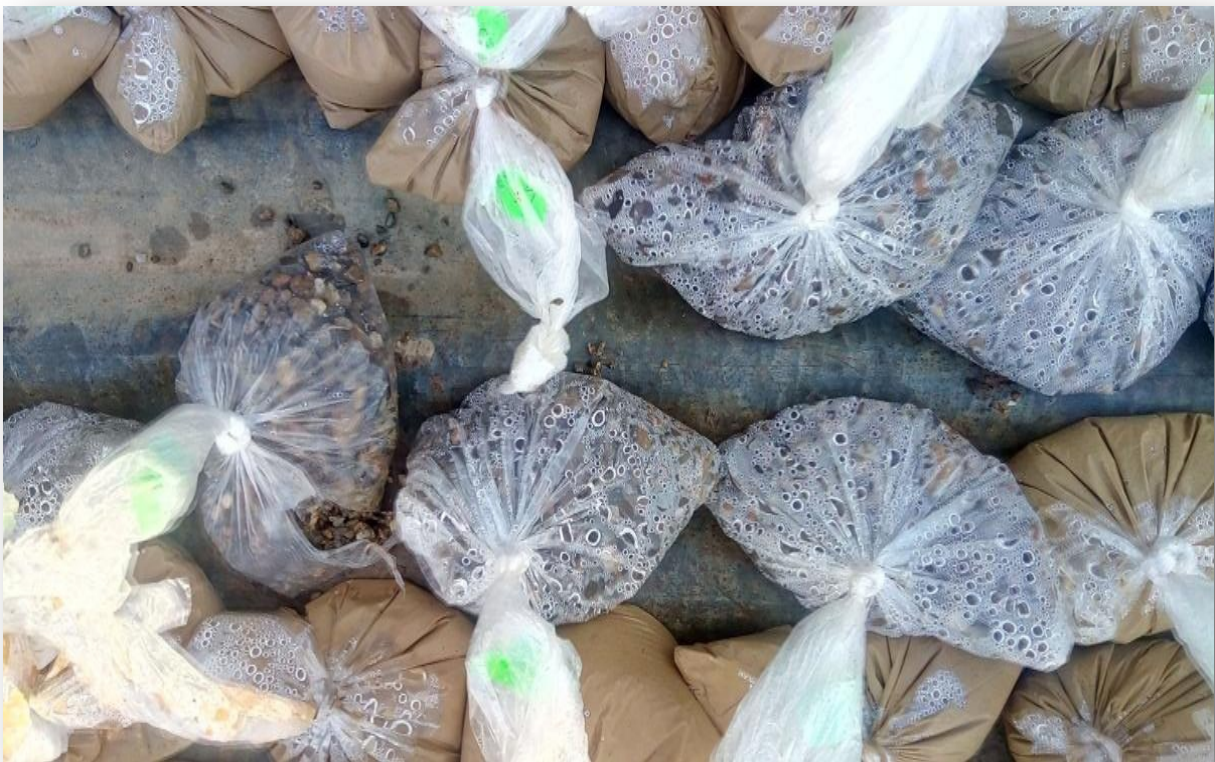
Figure IV-6 : Photo du conditionnement des cuttings dans des sachets étanches.
