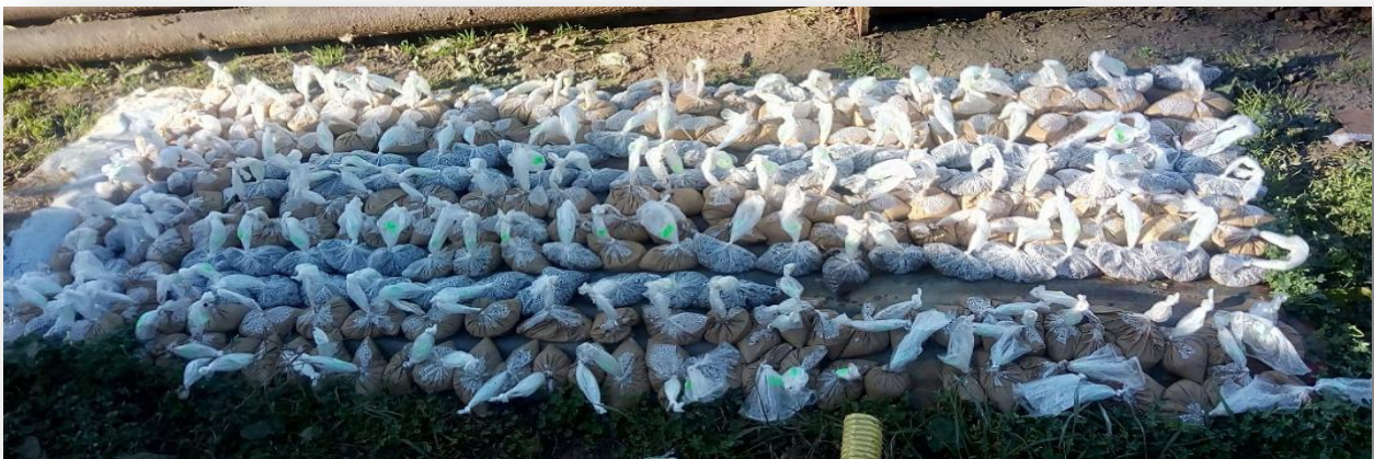
Figure IV-14 : Cuttings conditionnés dans des sachets étanches.
