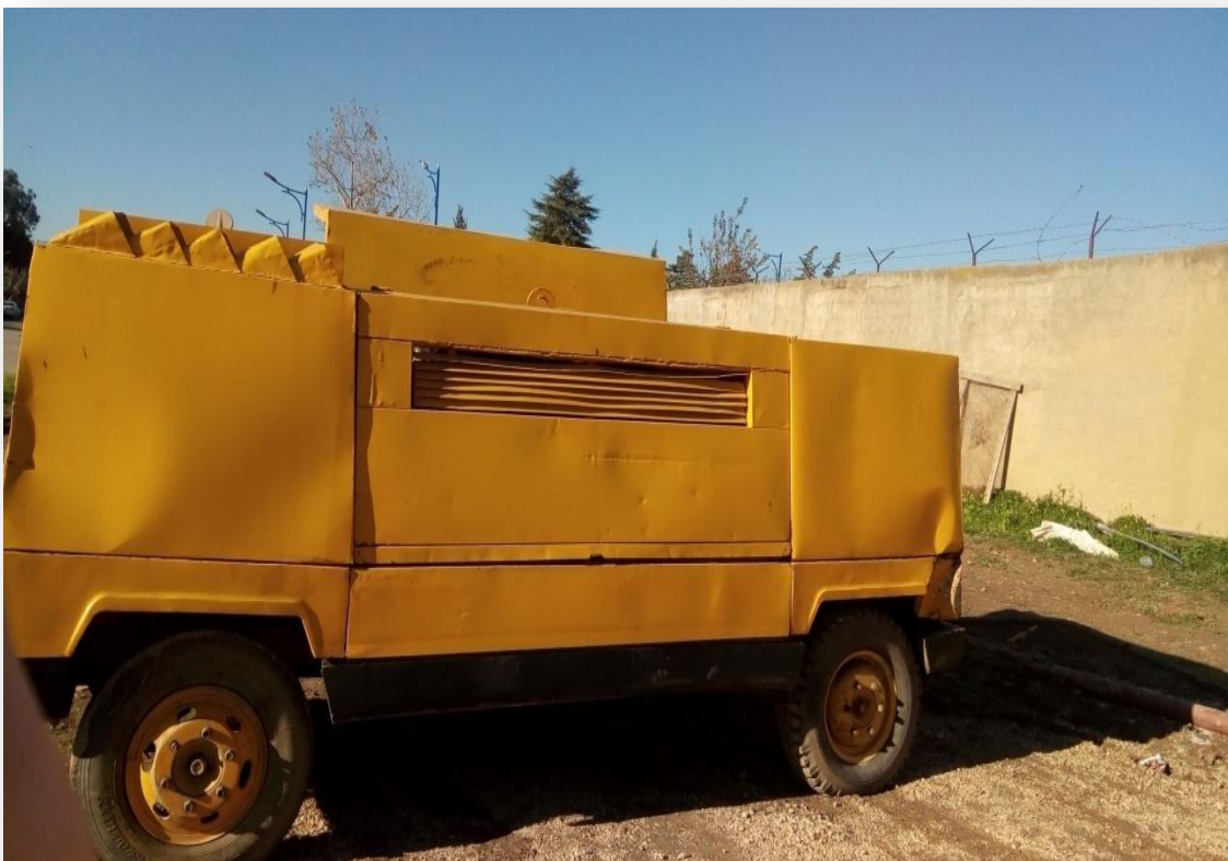
Figure IV-23 : Photo d'un compresseur de 16 bars
