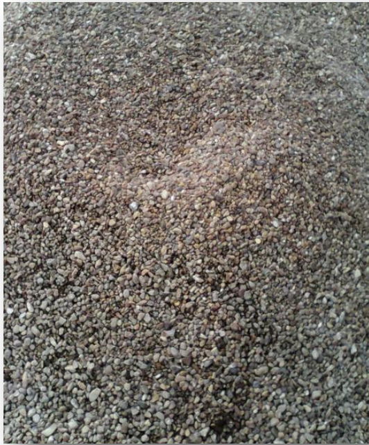
Figure IV-19 : Gravier additionnel du massif filtrant
