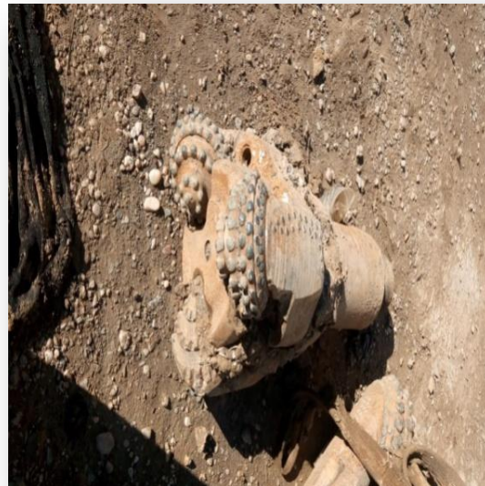
Figure IV-10 : Différents diamètres des outils de foration
