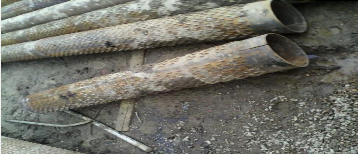
Figure IV-17 : Photo des tubes crépinés
