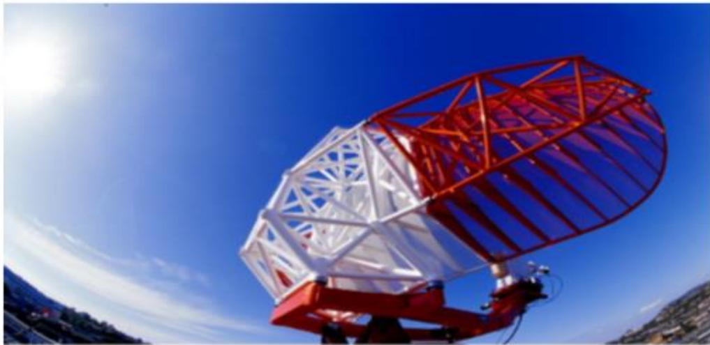
Figure II.3 Antenne du radar primaire
