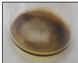
Figure II.5 : dépôts d'huile après le processus de vieillissement.
