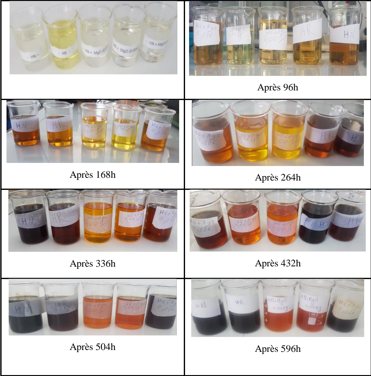
Figure.II.2 :Variation d'huile pendant le vieillissement thermique a 140°C.
