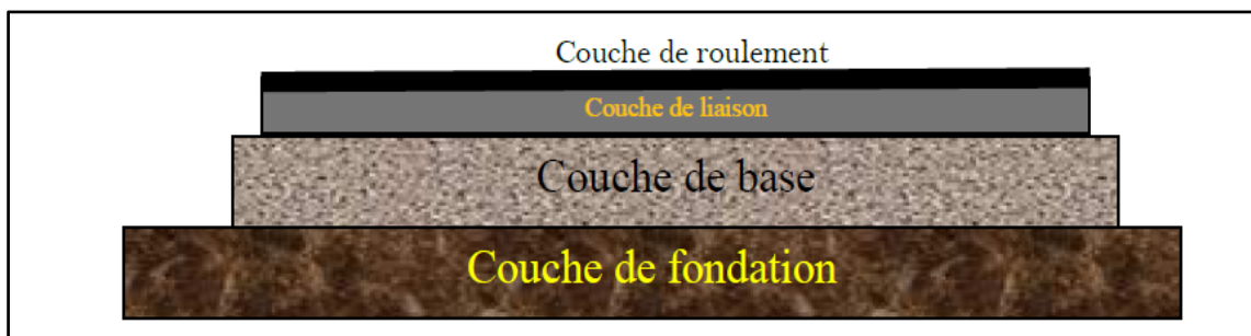
Figure I.4 : Différent couches des Chaussées souples[3]
