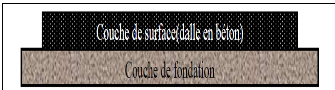
Figure I.5: Différents couches des chaussées rigides[3]
