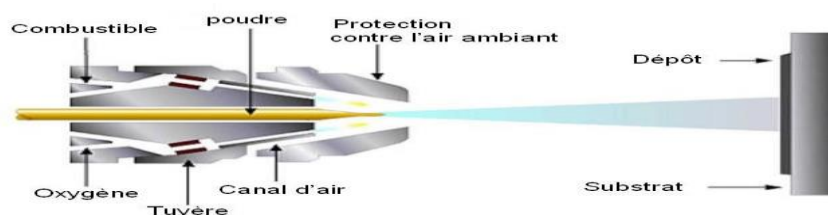
Figure II.3 : Schéma du procédé de projection par flamme [12].
