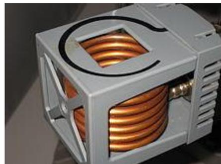
Figure. 1.3 : bobine l'air
