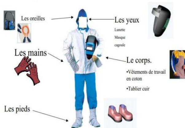
Figure.3.7 : Sécurité Les éléments nécessaires pour de bonne condition de travail.
