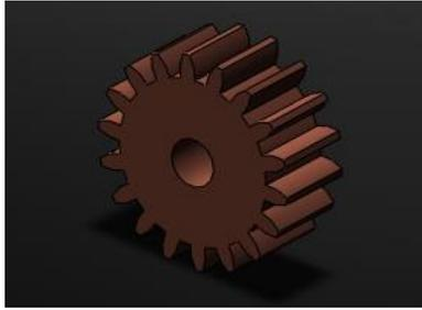
**Figure 4.13 : le satellite (élément dans la transmission planétaire).**
