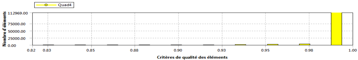
fig III-3-31 : Critère d'orthogonalité de qualité du maillage (NACA0012 avec bec)
