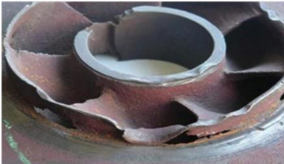
Figure (2.13) : Photo illustrant de cavitation sur un impulseur.
