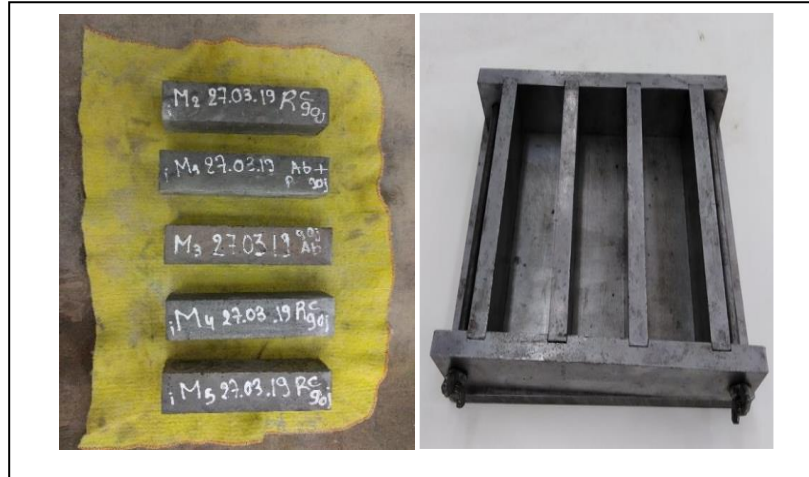
Figure 2. 9 : Confection des éprouvettes (4x4x16) cm 3 [56].
