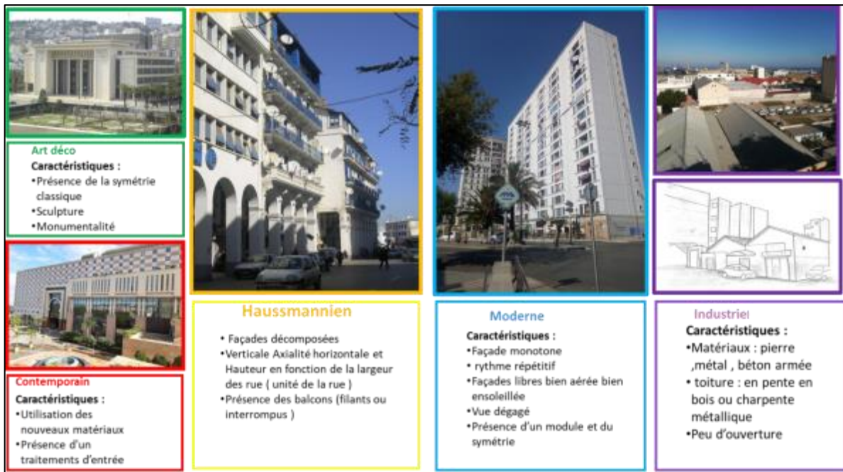
Figure 3.74:Typologie du bâti quartier El Hamma
