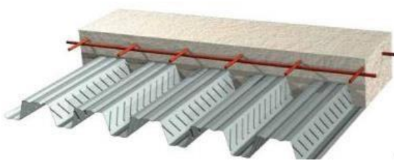
Fig218: les plancher collaborant Source : Google image , consulté le 19/05/2020
