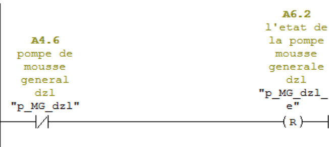
Réseau 13 : la vanne mousse au poste chargement 1
