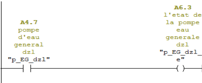
Réseau 11 : pompe d'eau general dzl
