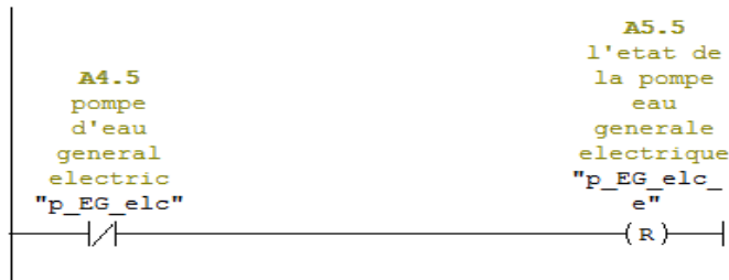
Réseau 14 : l'etat de pompe d'eau general electric
