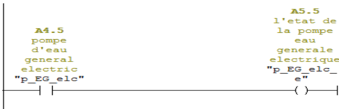
Réseau 10 : l'etat de la pompe eau generale electric
