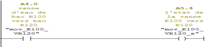
Réseau 5 : l'etat de la vanne E100 vers R120
