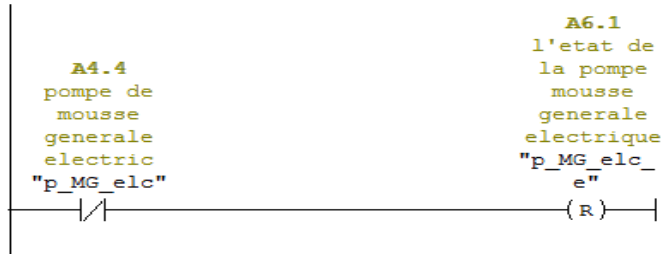
Réseau 15 : ouvreur des pompes d'eau et mousse dzl
