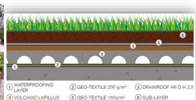
Figure 115 coupe des couches de la toiture végétalisée
