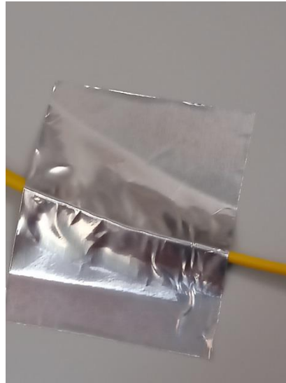
Figure 2.21 : Adhésif utilisé pour la mise en place des thermocouples.
