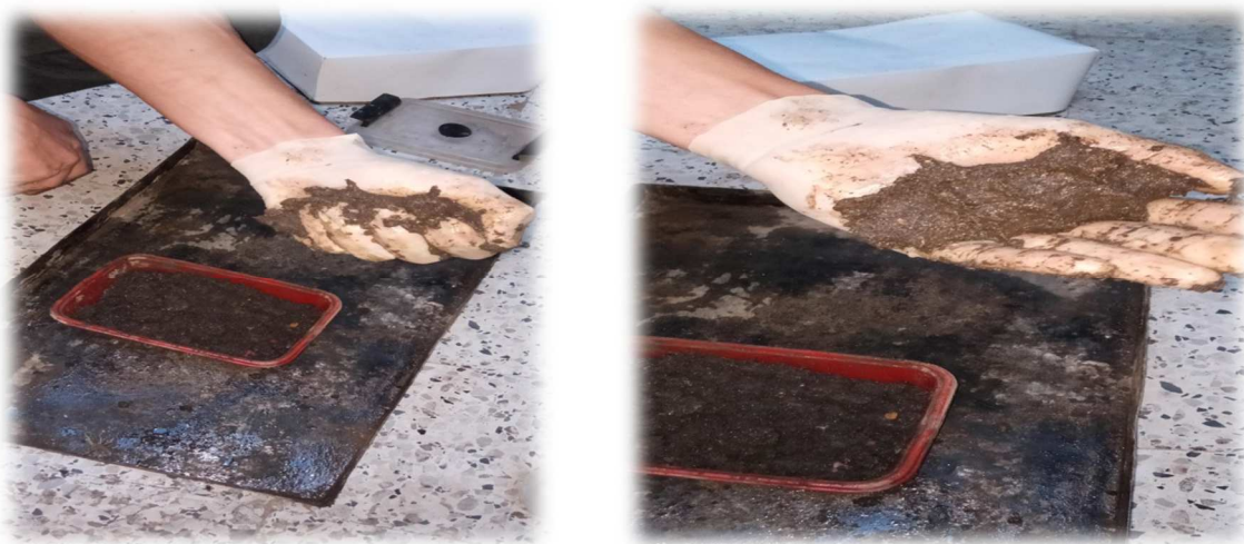
Figure II.26 : Mesure de l'humidité par méthode de poignée
