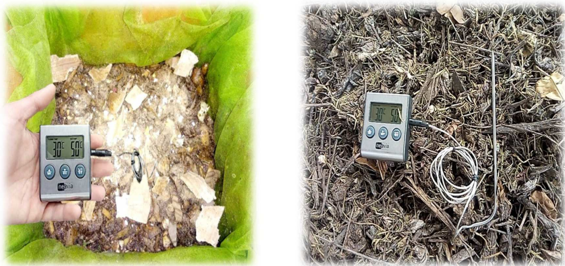
Figure II.25 : Mesure de température de vermicompost (à gauche) et andain (à droite)
