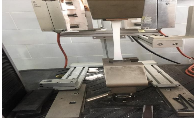
Figure 2.5 : L'essai de traction INSTRON sur l'un des films testé.
