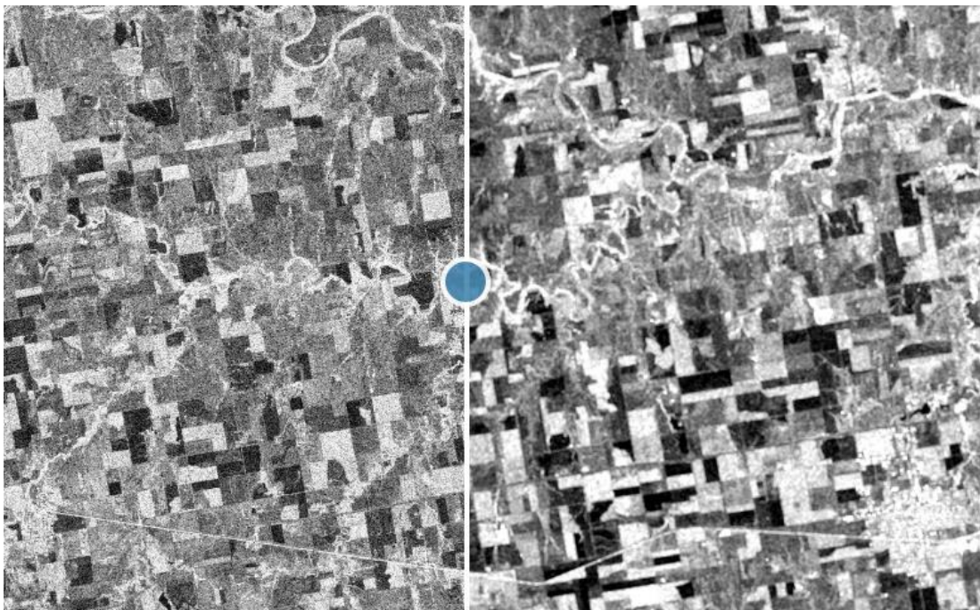
Figure (1.7) l'effet de filtre boxcar (9x9) sur les données SAR.
