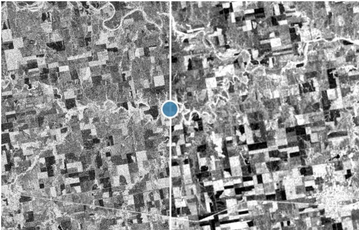
Figure (1.6) l'effet de filtre lee (9x9) sur les données SAR.
