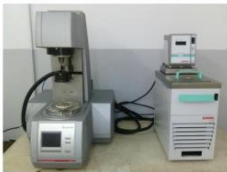
Figure 2.3 : rhéomètre de marque Anton Paar MCR302 piloté par le logiciel Rheosolve US
