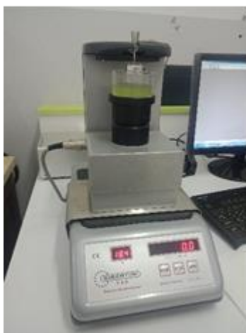
Figure 2.7: Tensiomètre de surface motorisé Gibertini DCA400.
