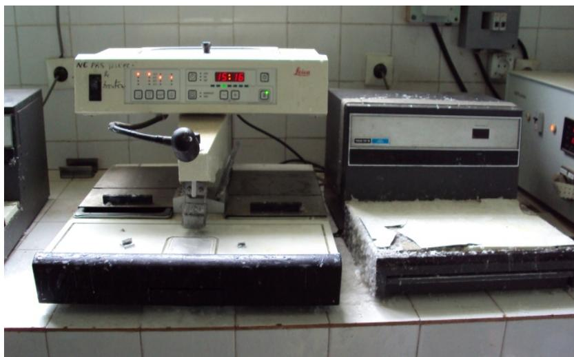
Bac à paraffine à droite, (Leica) ; plaque réfrigérée à gauche.
