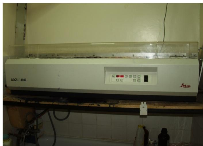
Appareil à coloration automatique (Leica ST 4040).
