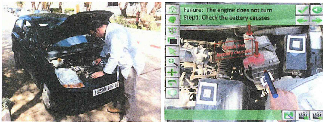
Figure 9 Un technicien utilise le système d'aide à la maintenance par la réalité augmentée pour maintenir son véhicule
