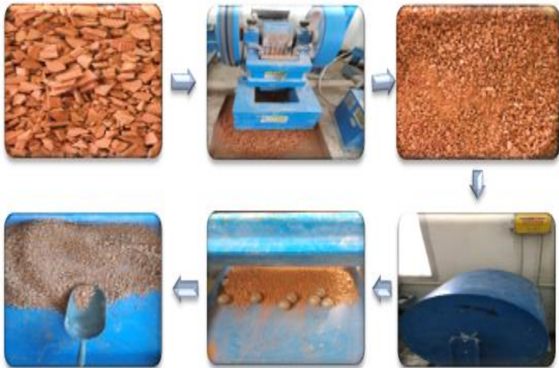
Figure II.7 : Processus de concassage du déchets de briques .
