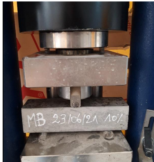
Figure II.18 : Essai de résistance à la flexion.
