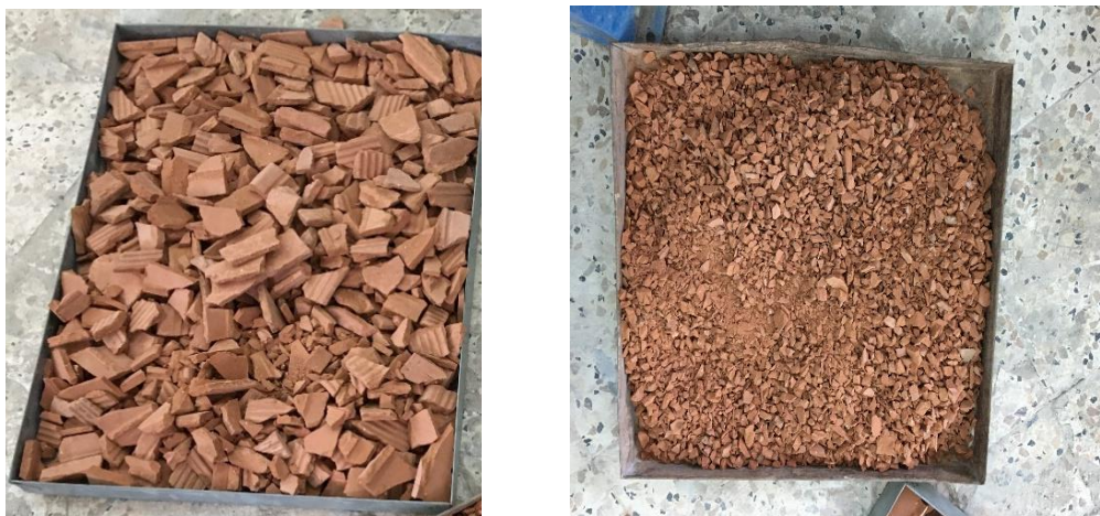
Figure II.6 : Déchets de brique utilisée avant et après concassage.
