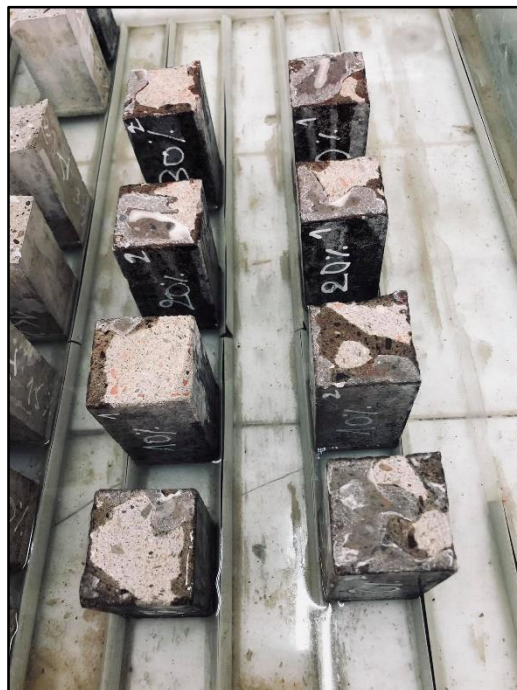
Figure II.20 : Essai d'absorption capillaire.
