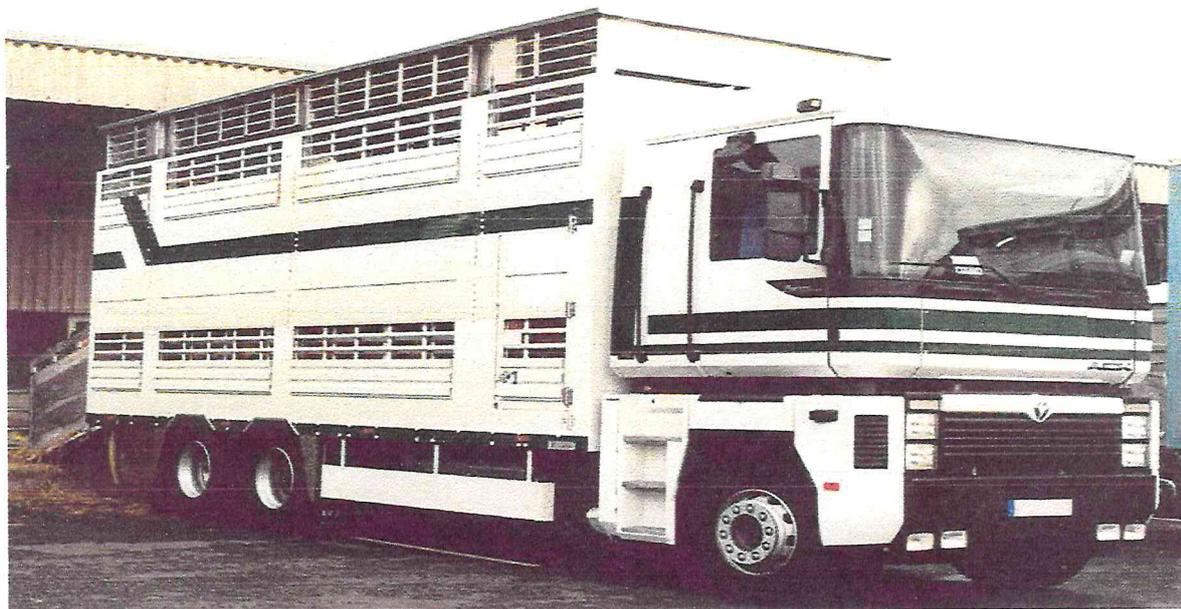
Figure numéro 1: Camion de transport a deux étages (11)
