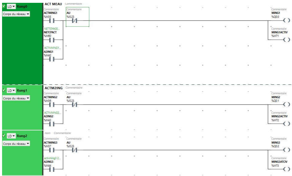
Figure 4.14 : Réseau activation désactivation des moteurs ingrédients.
