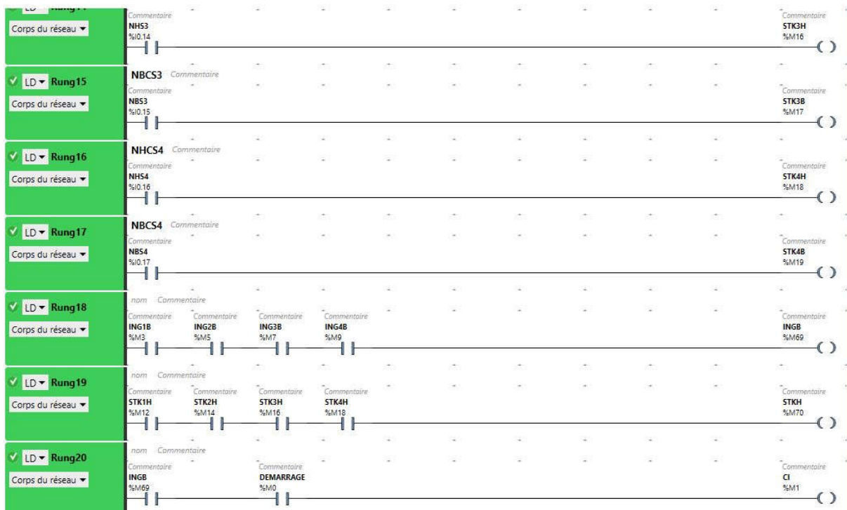
Figure 4.3 : Activation des capteurs de niveau des cuves de stockage
