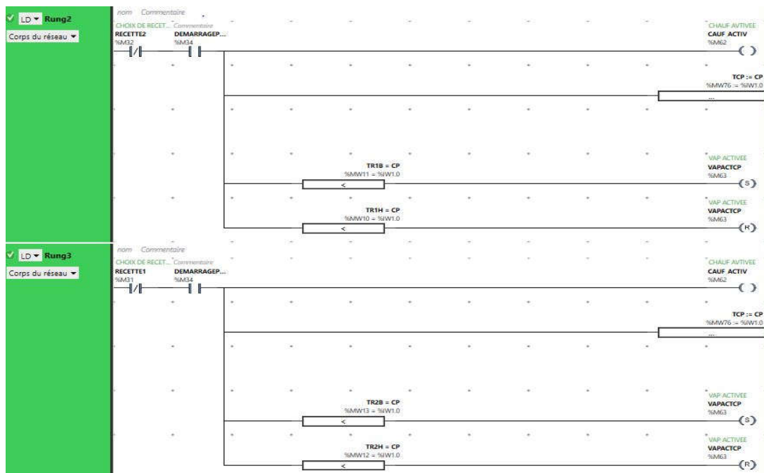
Figure 4.10 : Activation et désactivation du chauffage.
