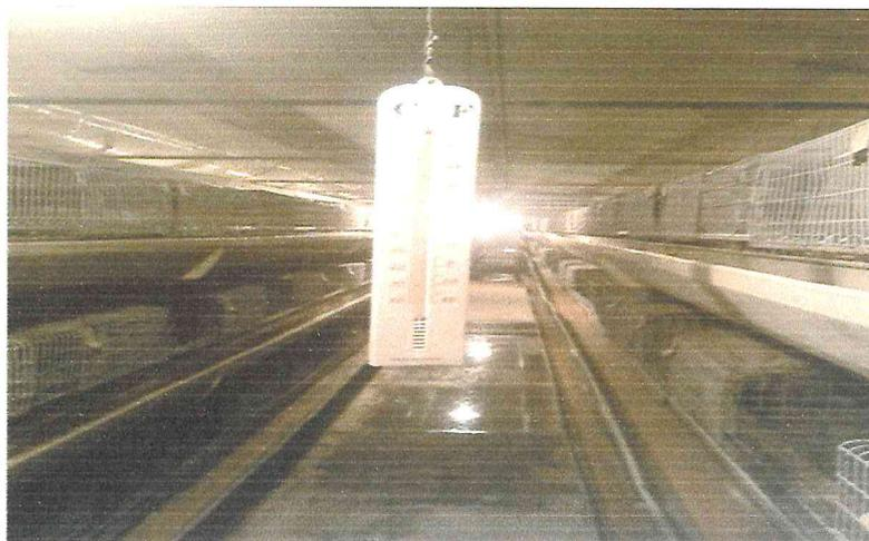
**Figure18** : sonde thermométrique (photo personnelle)
