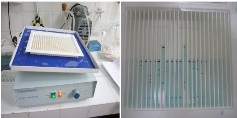
**Figure 25** : la plaque avec les bandelettes sur l'agitateur de plaque
