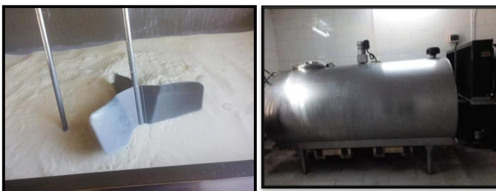
Figure 16-17 : Cuve de réfrigération du lait
