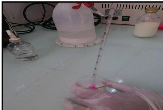
**Figure 21 : Titrer par la solution NaOH**
