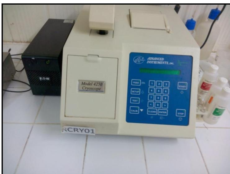
**Figure 22 : Cryoscope Cryostar**
