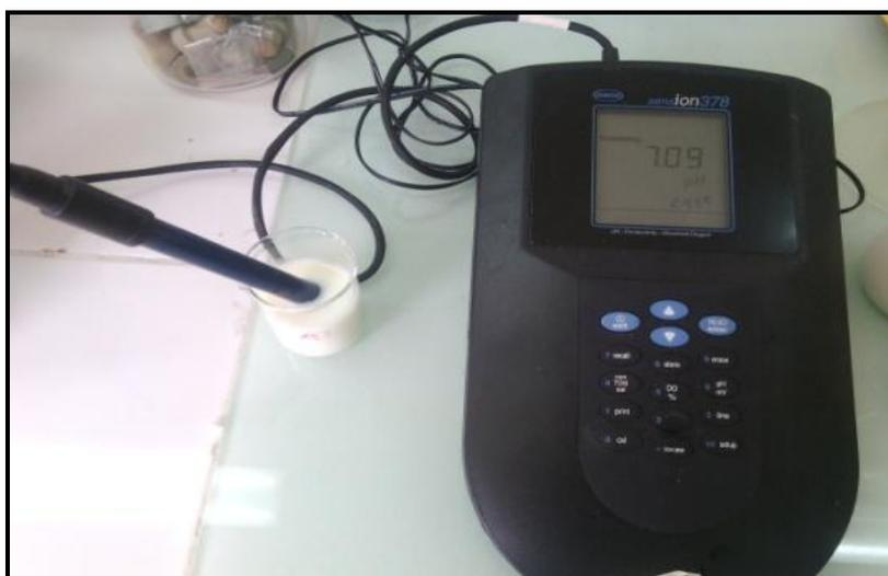
**Figure 20 : la mesure du pH par un pH- mètre**
