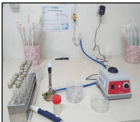
Figure 26: Vortex, Bec bunsen, portoirs, Tube à essai, pipette.
