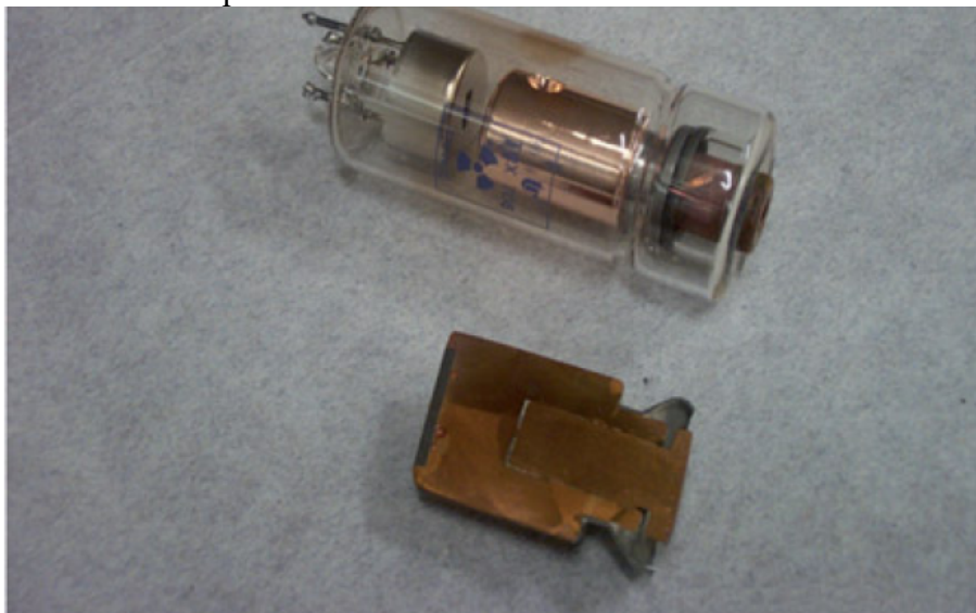
fig 1. 3: Tube de Coolidge exploité en radiologie dentaire (Fabrication Trophy® radiologie).
