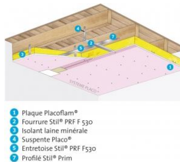
Figure 73: Détail faux plafond Source : Auteurs, 2020
