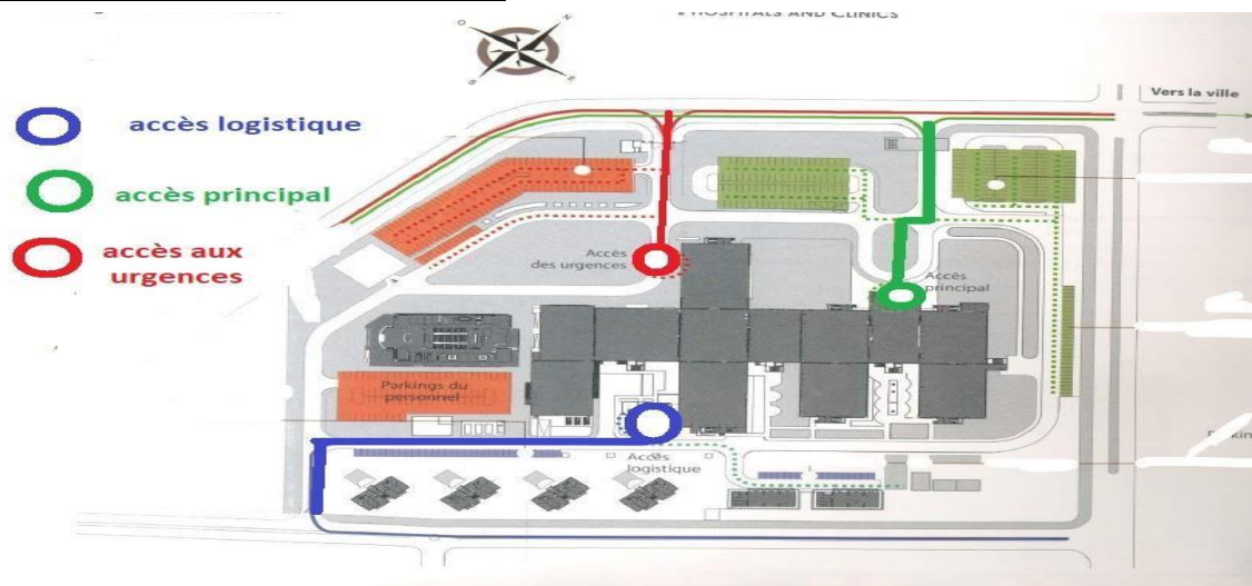
Figure 18 : les différents accès au projet Source : ZH architectes ; traité par les auteurs 2019
