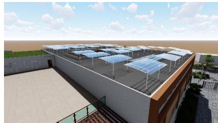
Figure 77: Panneau photovoltaïque sur le projet Source : les auteurs ,2020
