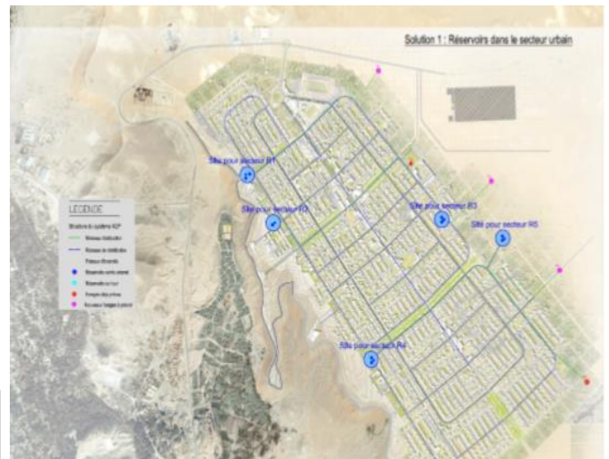
Figure 38 : Réseau d'alimentation en eau potable
