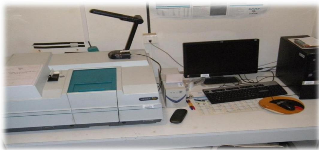
Figure II.4: Le Cary 500 est doté d'un double monochromateur en double faisceaux dont la forme spectrale s'étend de 175 nm à 3300 nm [manuel Carry 500].
