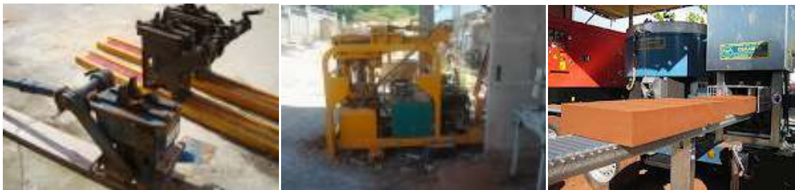
Figure II.1: Presse pour la fabrication de BTC
