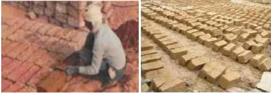
Figure III.04 : Moulage des briques en terre
