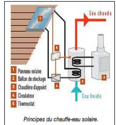
Figure V.11 Principe du chauffe eau solaire
