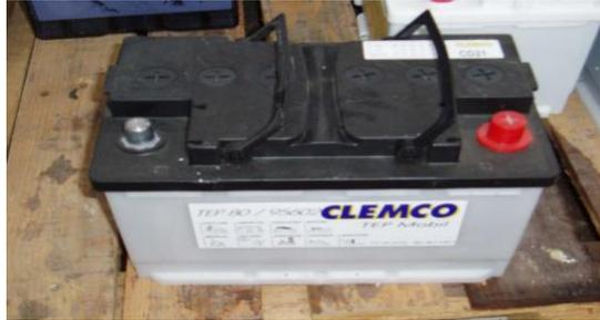
**Figure II.14.** Batterie de démarrage. [12]
