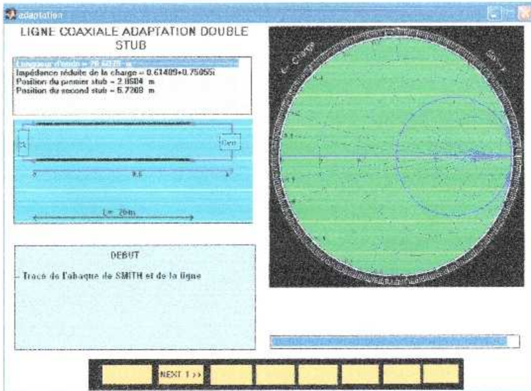
Figure V.15 : Adaptation deux stubs : Etape Initialisation
