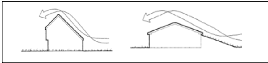
Figure 24: La forme du toit, vu l'implantation dans le terrain, minimise la prise au vent du bâtiment.
