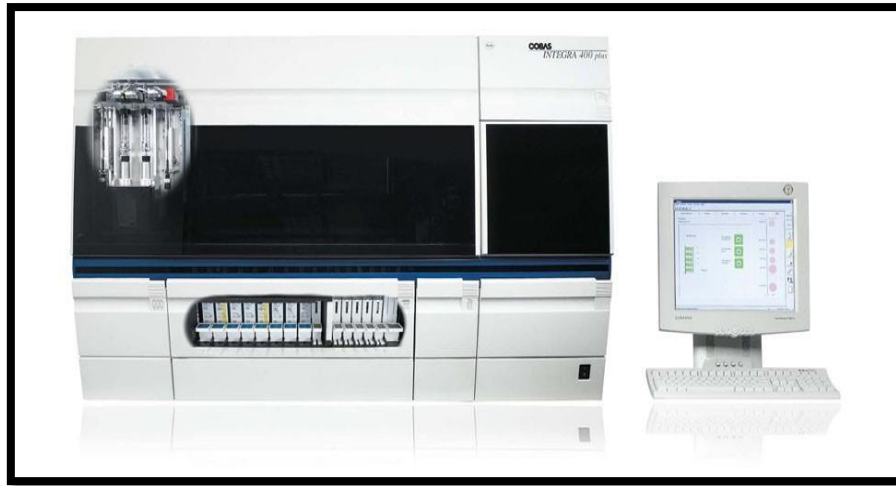
Figure 08 : l'automate COBAS INTEGRA 400 PLUS
