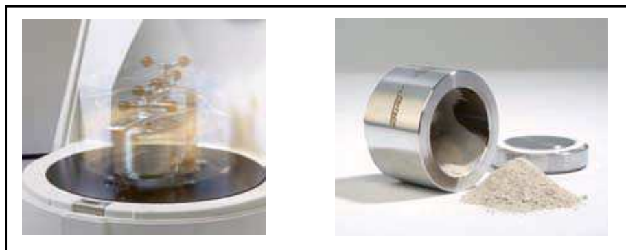
Figure 2 2 : Les jarres et les billes de broyage appropriés dans le PM400.
