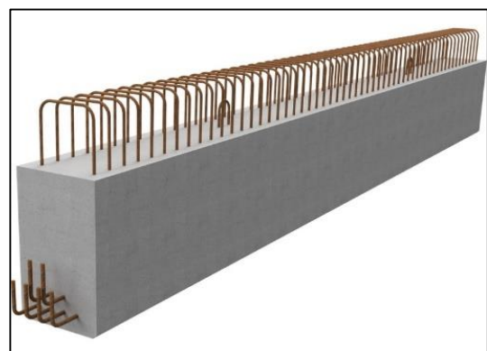
Figure 35. Poutre en béton précontraint
