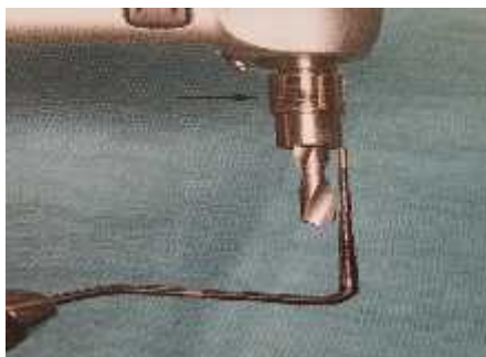
Fig 62 : Utilisation des butées (flèche) spécifiques aux forets.
