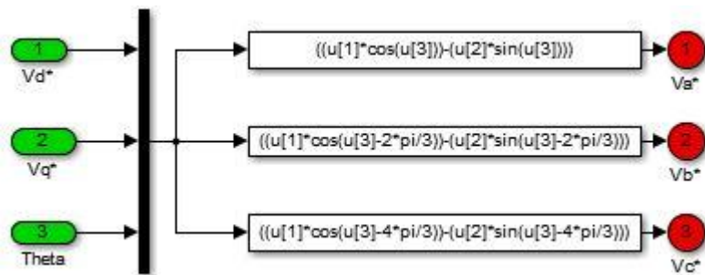
Fig. (B.05) : Bloc de Transformation de Park Inverse
